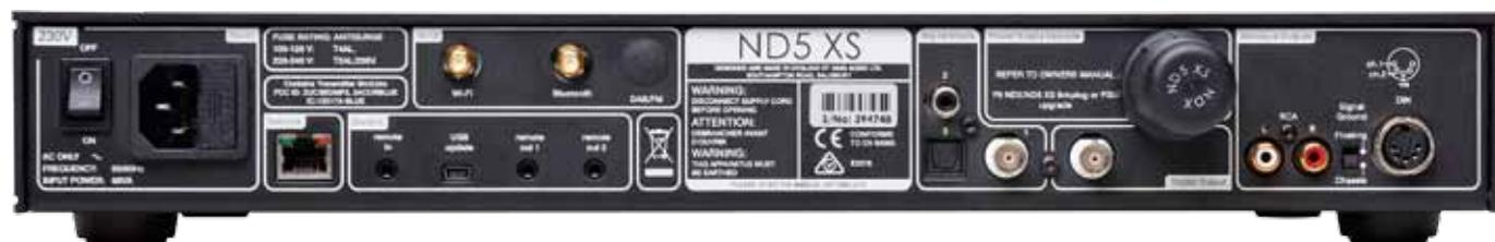
Trotz der übersichtlichen Rückseite hat der Naim einiges an Ein- und Ausgängen zu bieten. Dazu gehören WLAN- und Bluetooth-Schnittstelle, Ethernet-Anschluss, drei Digital-Ins (BNC, Cinch und TosLink), ein Digital-Out, Analoge Cinch-Ausgänge und der Naim-typische 5-Pol-Din-Ausgang. Der große Brückenstecker rechts neben den Digitaleingängen wird benötigt, wenn man kein optionales Naim-Netzteil besitzt
