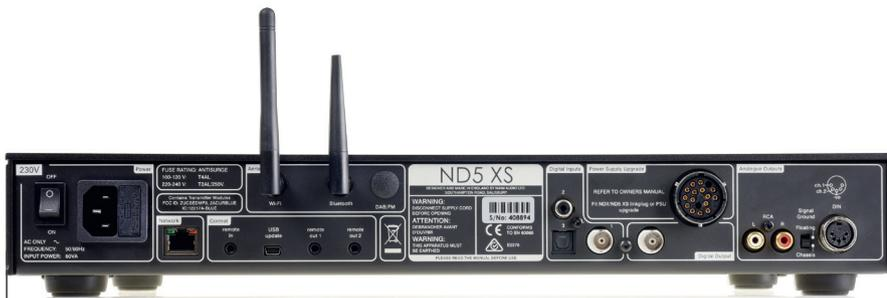
**DREI GEHEN REIN, EINER KOMMT RAUS:** Der Naim nimmt digitale Signale via Toslink, BNC und Cinch entgegen, gibt sie aber nur über BNC aus. Die kleine Antenne neben der WLAN-Antenne ist für Bluetooth zuständig.
