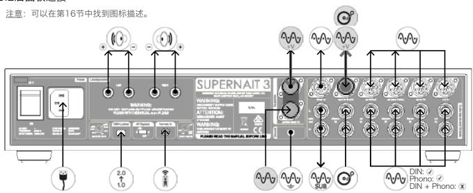
注意: 仅在将使用电源升级或可选前置放大器将使用 SUPERNAIT 3功率放大器选择时需将连接插头拔掉。在所有 其他情况下, 应始终保持连接插头处于连接状态。
