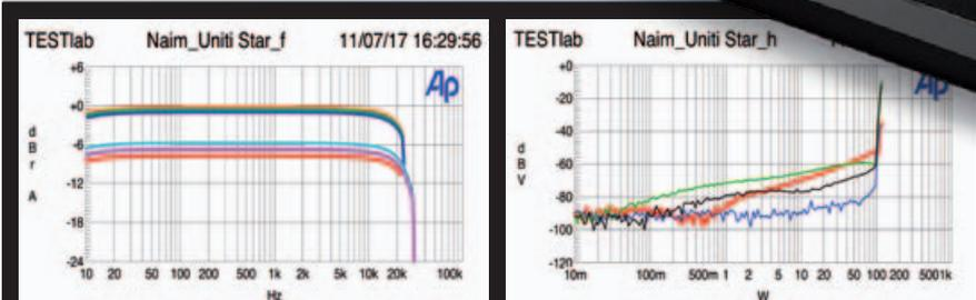
Naim begrenzt den Übertragungsbereich auf den hörbaren Bereich – Signalanteile jenseits von 22 kHz lässt der Verstärker nicht passieren. Die Kurven zeigen den Frequenzgang an 8,4 und 2 Ohm (oben) und darunter den mit Digitalton (192/96/44,1 kHz). Der Klirrharmischen-Verlauf (rechts) ist unauffällig, die dynamische Leistung liegt zwischen 70 und 130 Watt an 8 bzw. 2 Ohm). **AUDIO-Kennzahl 57**
